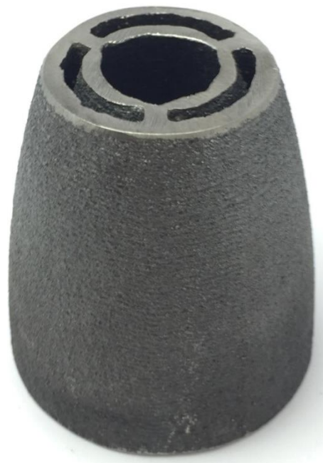
Наименование: Лопатка НПО «Сатурн» Материал: никелевый суперсплав In625 Время изготовления: 3 часа
