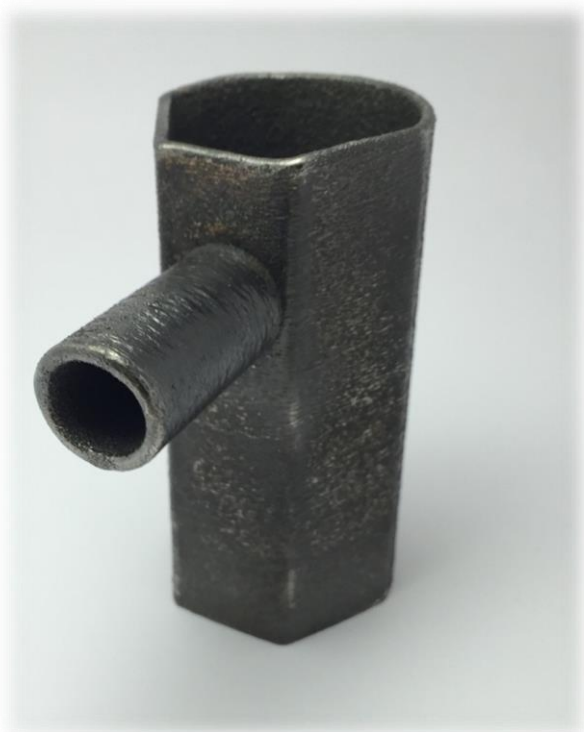
Наименование: Тонкостенный образец Материал: нержавеющей сталь 316L Время изготовления: 1 часа 15 минут
